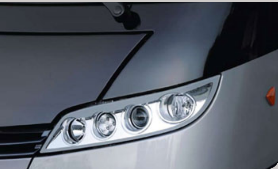
► Feux type bus avec système Bi-halogène, feux de jour et feux de virage statiques (en option)
